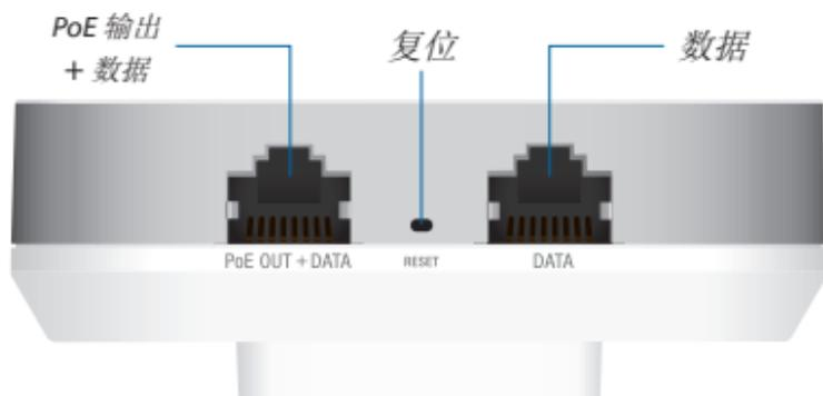
**PoE Out + Data (PoE 输出 + 数据)** 支持数据传输和 PoE 输出的 10/100/1000 以太网端口(需要 802.3at PoE+ 输入)。最大 PoE 传送输出为 12W。
