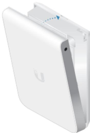
6. 可选：使用附带的 Torx 或 Phillips 安全螺丝将盖板固定到 UAP-IW-HD 上。
