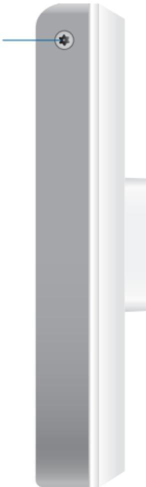
**安全螺丝**（可选）安全螺钉可在安装后固定盖板。您可以选择使用随附的 Torx（已随附）或飞利浦安全螺丝。
