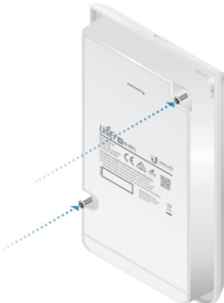
5. 将盖板安装到 UAP-IW-HD 的底部。然后将盖板按压到固定位置，直到安装卡舌卡入到位。
