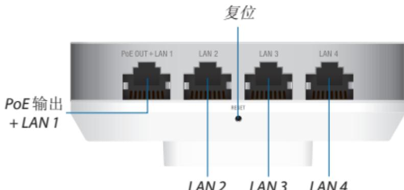
**PoE Out + LAN 1** 10/100/1000 以太网端口支持数据和 PoE 直通（需要 802.3at PoE + 输入）。最大 PoE 直通输出为 12W。
