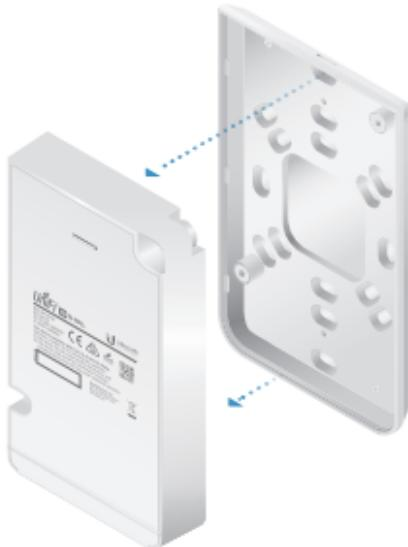
2. 将以太网线穿过背部面板，然后使用壁挂式螺钉将背部面板连接到墙盒上。
