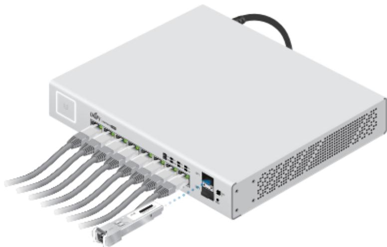
3. 将光纤电缆连接至光纤 SFP 模块。
