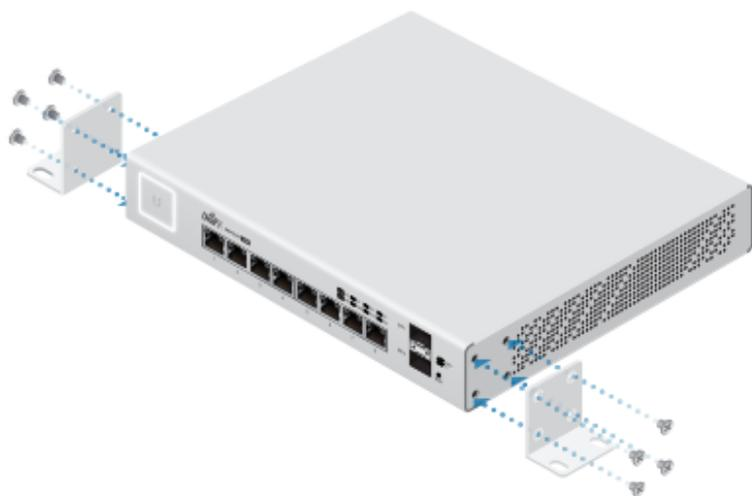
2. 用 4 颗安装螺丝将 UniFi 交换机锁紧在支架上。
