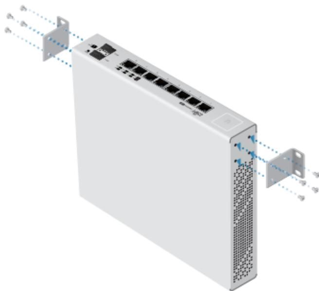
2. 用 4 颗螺旋栓和安装螺丝将 UniFi 交换机锁紧在墙壁上。
