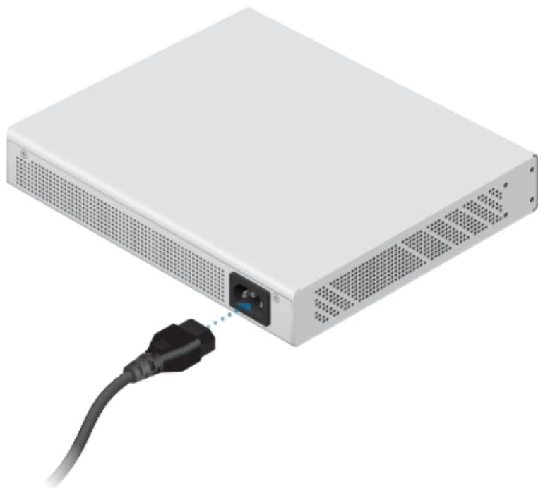
2. 将电源线连接至 UniFi 交换机后方的电源端口。
