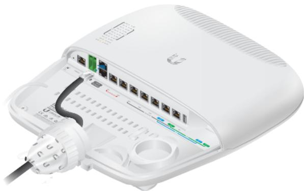
2. 将以太网线的另一端连接到千兆位 PoE 电源适配器上的 POE 端口。
