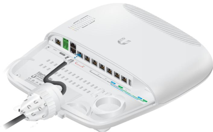
3. 将一个电缆扎带(未随附)穿过电缆下面的扎带槽,并绑紧,以避免网线被应力拉脱。然后,将线缆扎带绕在线缆上并拧紧。
