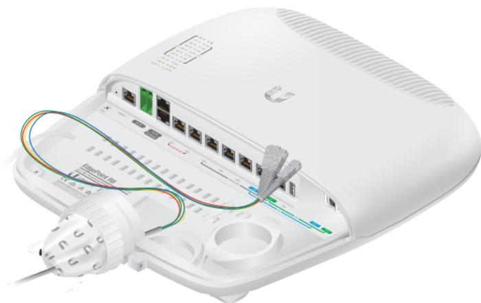
4. 分离光纤线股，并按箭头方向将线股缠绕在应力消除绕线轴上。然后，将光纤连接到光纤模块。
