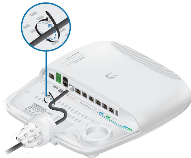
4. 将以太网线的另一端连接到网络设备。
