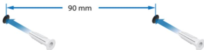
2. 使用十字螺丝刀将螺丝安装到各个固定锚。在螺丝头和墙壁之间留出大约3mm空间。
