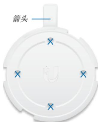
3. 如果以太网线穿过墙壁，请切割或钻一个直径约为 18 mm 的圆孔。将 CAT5/6 电缆从孔中穿过。
