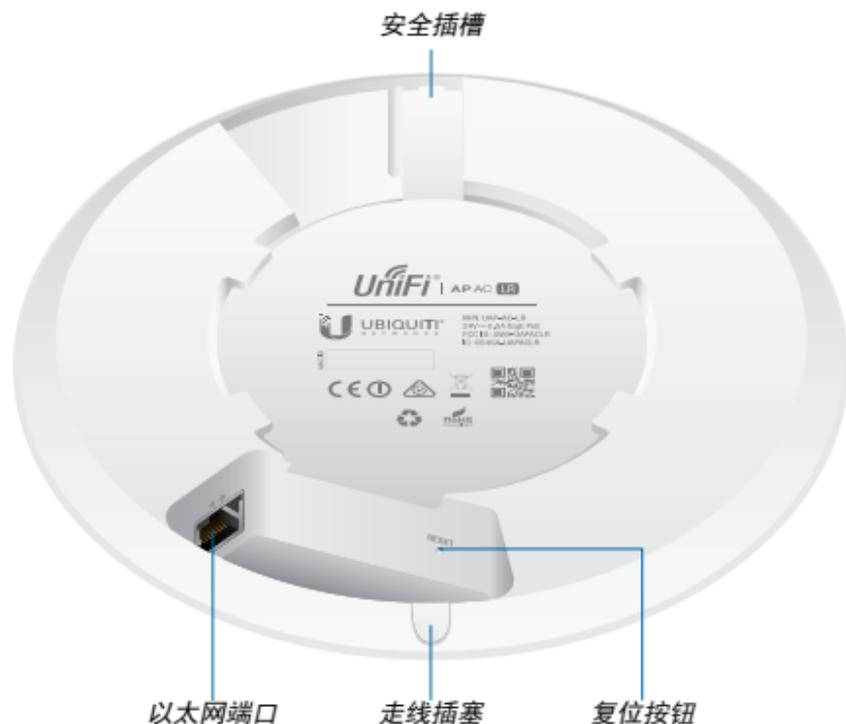
**Locking Notch(锁紧凹槽)** 锁紧凹槽将与安装支架配合使用，以帮助固定 UniFi AP。（相关内容参见安装支架部分。）
