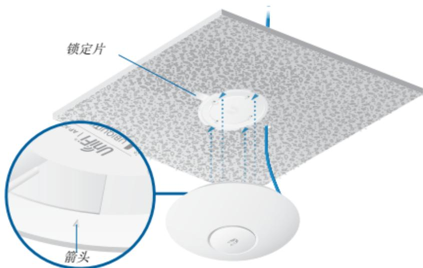
8. 确保 UniFi AP 牢固地安放在安装支架上。顺时针转动 UniFi AP，直至其锁定到位，且锁定片牢固地固定到锁紧凹槽中。
