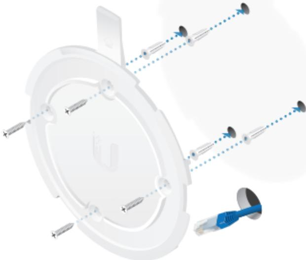
5. 如果以太网线沿安装表面走线，请取下走线插塞。
