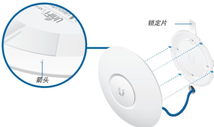
8. 确保 UniFi AP 牢固地安放在安装支架上。顺时针转动 UniFi AP，直至其锁定到位，且锁定片牢固地固定到锁紧凹槽中。
