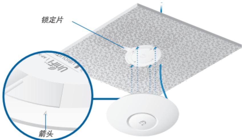
8. 确保 UniFi AP 牢固地安放在安装支架上。顺时针转动 UniFi AP，直至其锁定到位，且锁定片牢固地固定到锁紧凹槽中。
