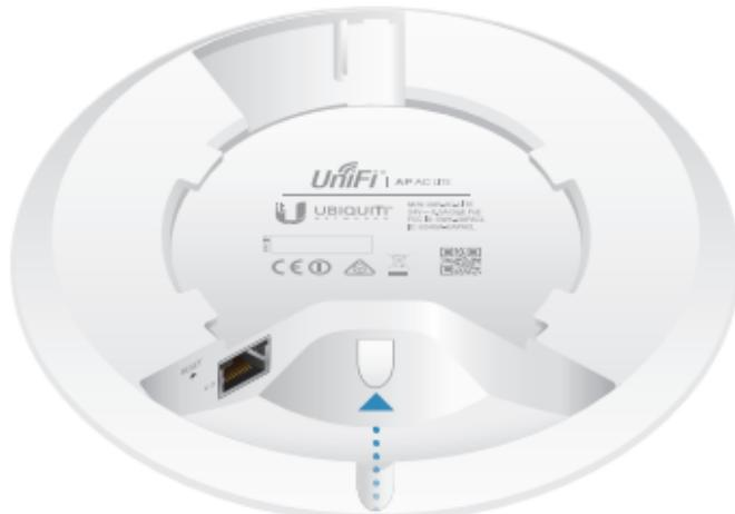
6. 将以太网线连接至以太网端口。
