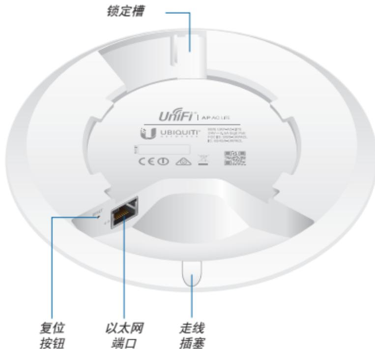
**Locking Not (锁紧凹槽)** 锁紧凹槽与安装支架配合使用，以帮助固定 UniFi AP。(相关内容参见安装支架部分。)
