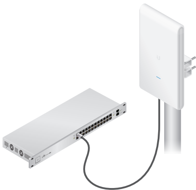
连接到 UniFi 交换机，型号：US-24-250W
