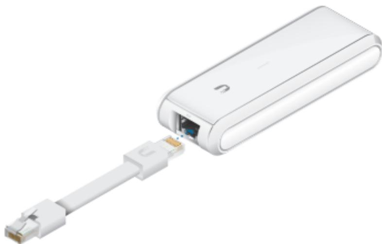
2. 将以太网线的另一端连接至网络交换机 (如 UniFi 交换机) 的端口上。
