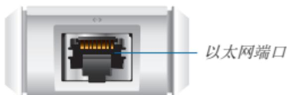
**以太网** 千兆位以太网端口用于连接电源，连接到 LAN 和 DHCP 服务器。可通过 802.3af PoE 交换机供电，如 Ubiquiti Networks UniFi 交换机。
