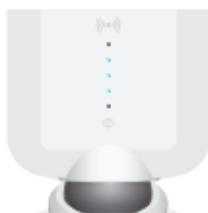
中间三个 LED 将连续闪烁，表示 Mesh Point 已准备就绪，可以进行配置。
